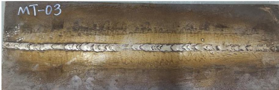
平板对接焊缝 MT-03
