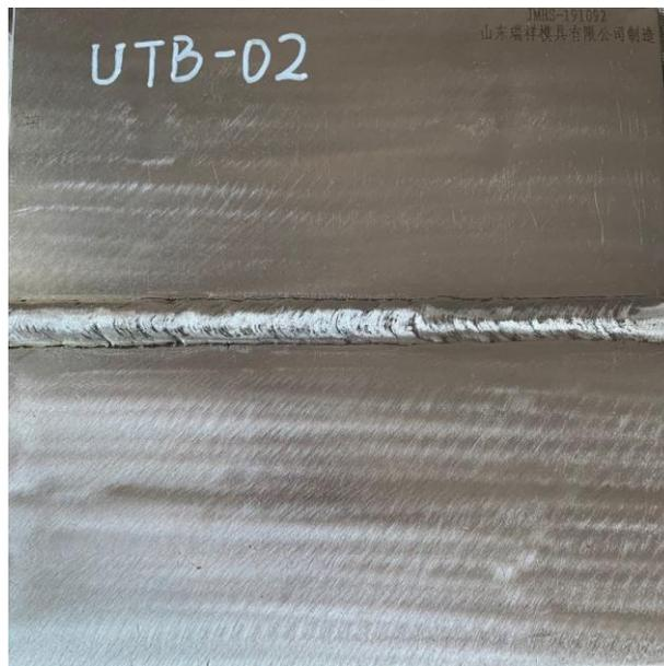
平板对接焊缝 UTB-02
