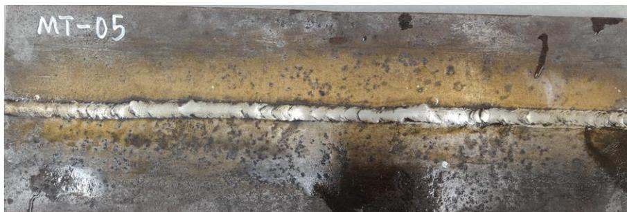
平板对接焊缝 MT-05
