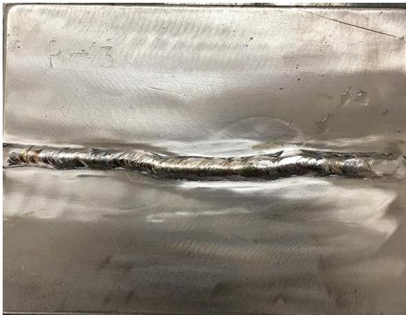
平板对接焊缝 P-3
