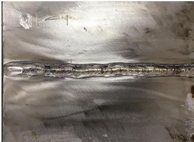
平板对接焊缝 P-1
