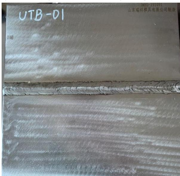
平板对接焊缝 UTB-01
