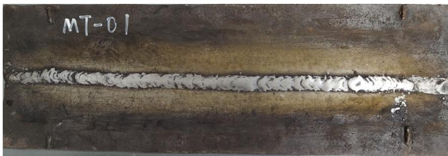
平板对接焊缝 MT-01
