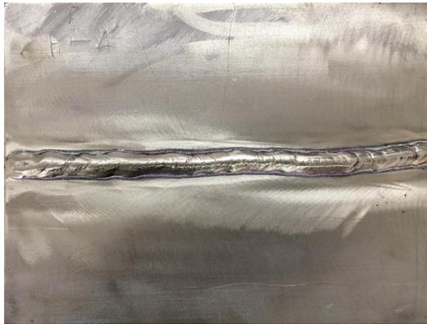
平板对接焊缝 P-4
