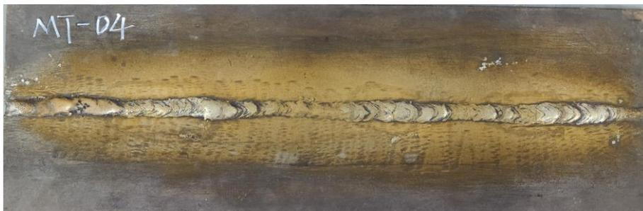
平板对接焊缝 MT-04
