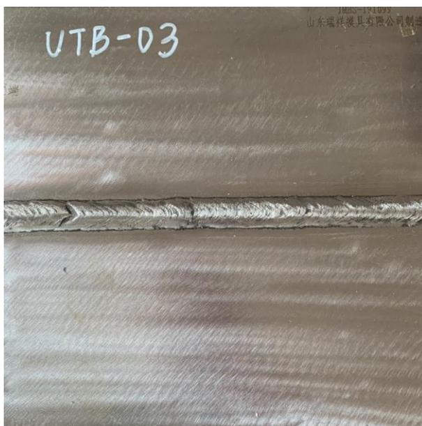
平板对接焊缝 UTB-03
