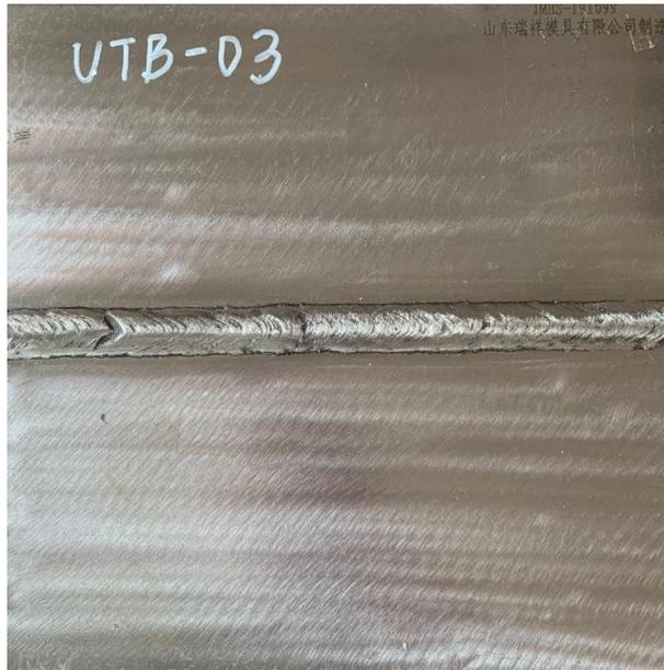
平板对接焊缝 UTB-03
