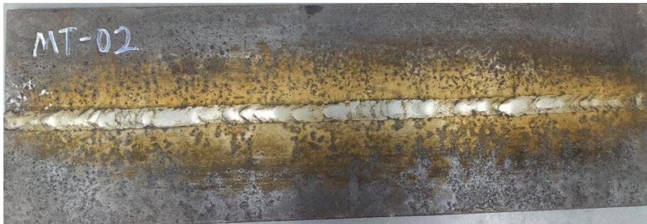
平板对接焊缝 MT-02
