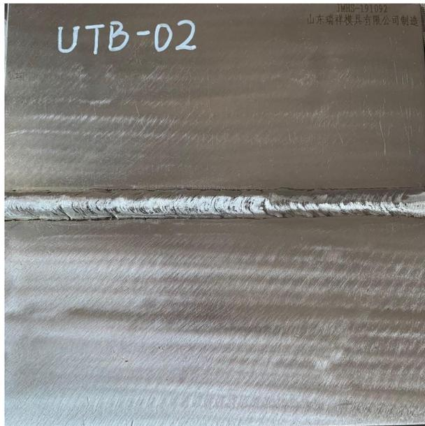
平板对接焊缝 UTB-02
