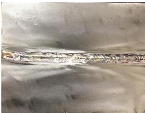
平板对接焊缝 P-2
