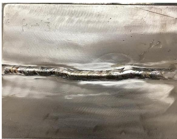
平板对接焊缝 P-3
