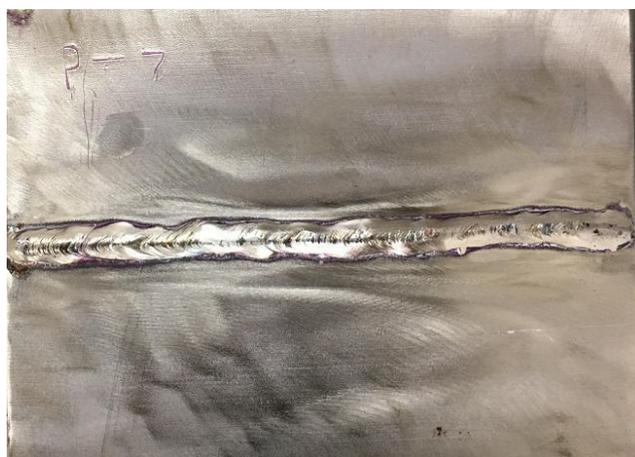
平板对接焊缝 P-7
