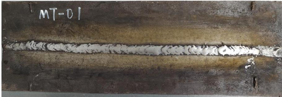
平板对接焊缝 MT-01
