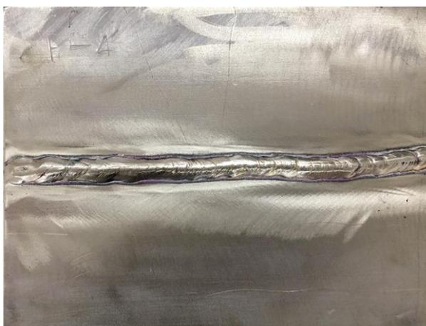
平板对接焊缝 P-4
