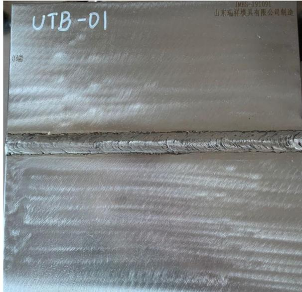
平板对接焊缝 UTB-01
