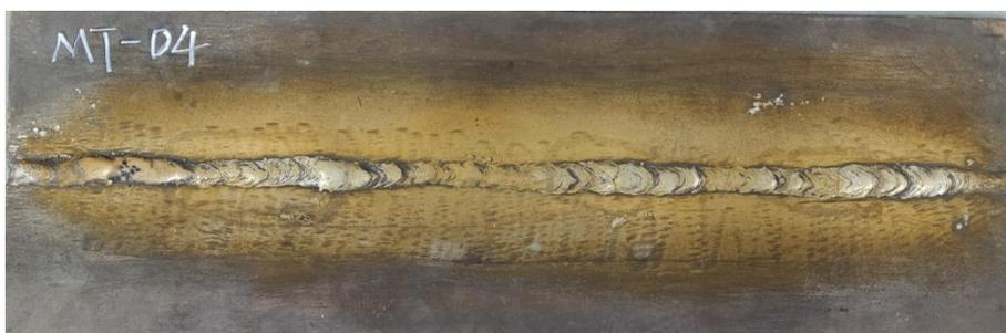
平板对接焊缝 MT-04
