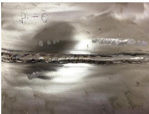
平板对接焊缝 P-6
