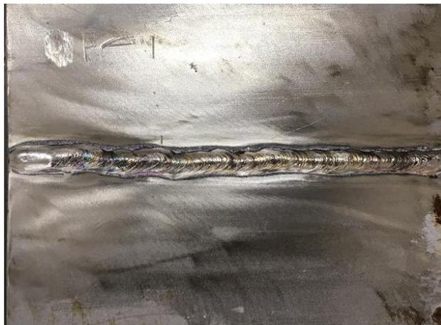
平板对接焊缝 P-1
