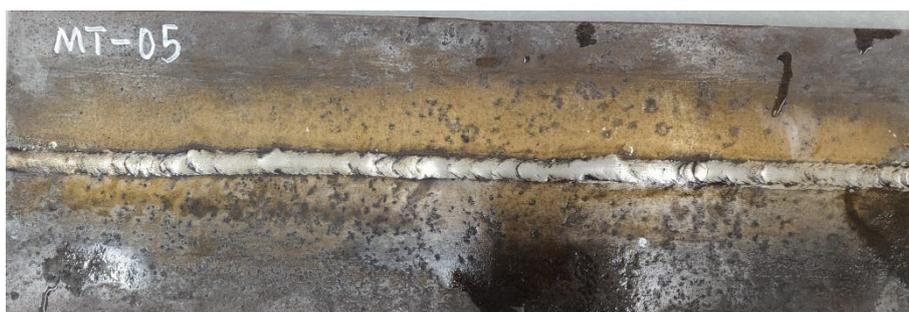
平板对接焊缝 MT-05
