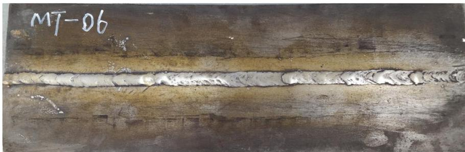
平板对接焊缝 MT-06
