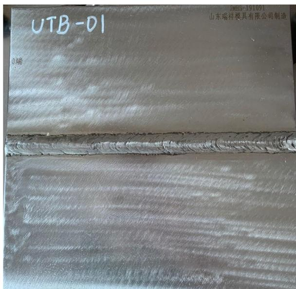
平板对接焊缝 UTB-01
