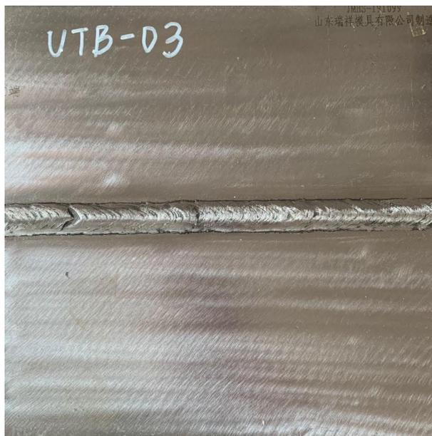
平板对接焊缝 UTB-03
