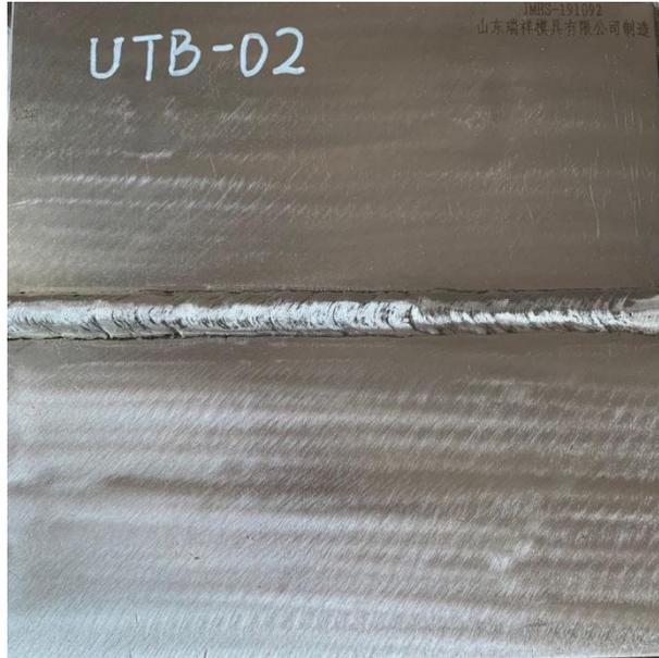
图 K1-12-1 平板对接焊缝 UTB-02
