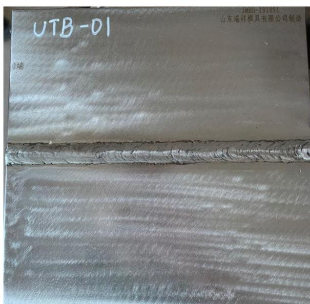
图 K1-11-1 平板对接焊缝 UTB-01
