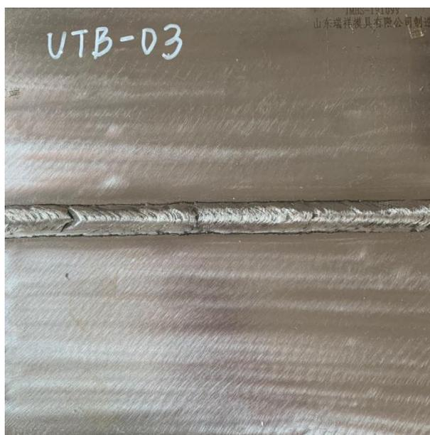
图 K1-13-1 平板对接焊缝 UTB-03
